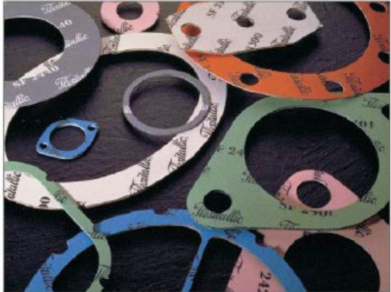
El material Thermiculite de Flexitallic es un material versátil para juntas de sellado basado sobre los minerales de vermiculita exfoliada. El producto está disponible con un núcleo de metal reforzado o sin núcleo y está diseñado para ser utilizado en temperaturas que excedan la capacidad de las láminas o placas basadas en grafito. La capacidad de temperatura de la fibra de asbesto comprimido (CAF) es también excedida por el material Thermiculite.
