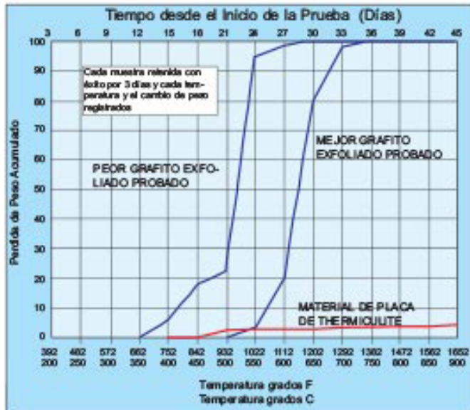
Resultados acumulados de la pérdida de peso iso-térmica para los mejores y los peores grafitos exfoliados probados
