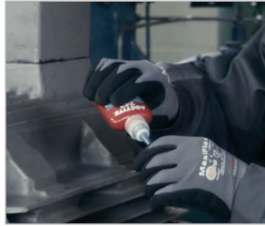
Aplique sellador para roscas (p. ej. Loctite® 243™) en todas las piezas de conexión, atornille manguito reductor
