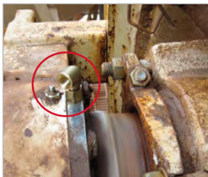
Coloque reductores y codos en la aplicación
