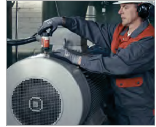
Retire el tapón y atornille el sistema de lubricación en el punto de lubricación
