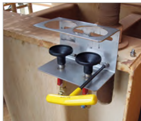
Fije el soporte a la pinza de montaje
