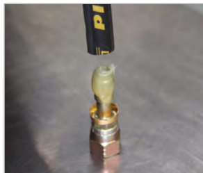
Aplique grasa al conector para manguera
