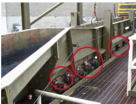
Lubricación del cojinete en la clasificación de árbol
