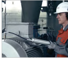
Prelubrique el punto de lubricación y las piezas de conexión, llene previamente las líneas de grasa (use el mismo lubricante que en el sistema de lubricación)
